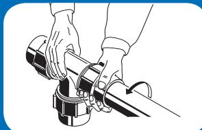
Inserire l'anello di graffaggio sul tubo e portarlo fino a battuta.
