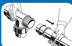
Lubrificare l'estremità del tubo ed inserirlo all'interno del corpo del raccordo fino a battuta. Spingere l'o-ring e la bussola all'interno del raccordo.
