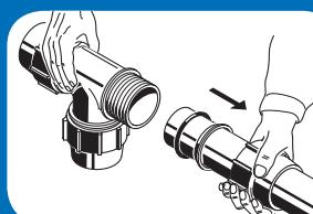
Graisser l'extrémité du tube et l'introduire à l'intérieur du corps du raccord jusqu'à ce qu'il soit en butée. Pousser le joint torique et la bague de serrage à l'intérieur du raccord.
