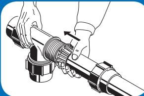
Visser la douille sur le corps du raccord.
