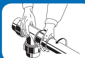
Introduire la bague de sertissage sur le tube jusqu'à ce qu'elle soit en butée.
