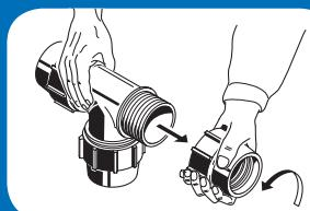
Introduire la douille, la bague de serrage et le joint torique sur le tube.
