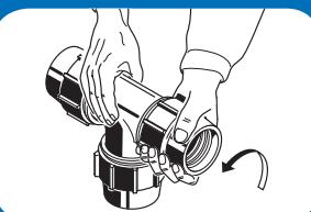
Introduire le tube dans le corps du raccord en passant le joint torique jusqu'à ce qu'il soit en butée.
