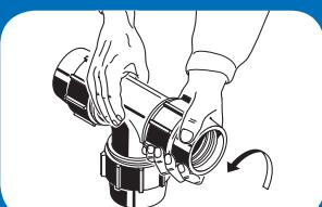
Inserire il tubo nel corpo del raccordo passando l'o-ring finchè non arriva a battuta.
